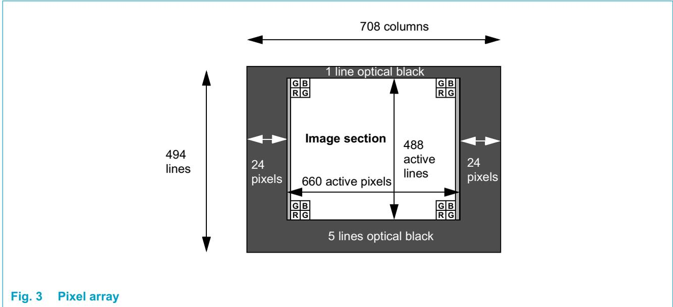
Fig. 3 Pixel array
